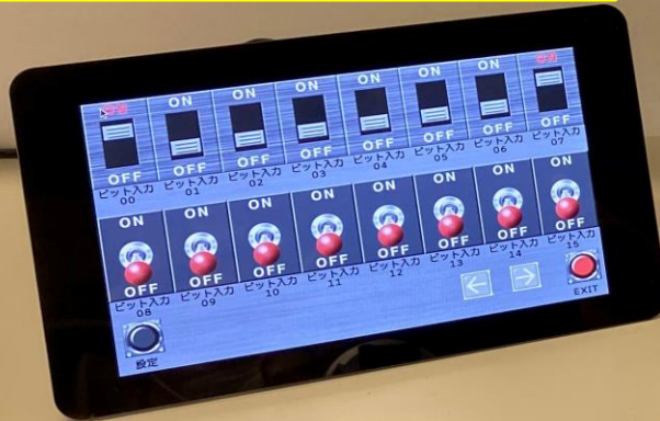
ソフトPLC内蔵コントローラ (CPUボード、LCDタッチパネル)
